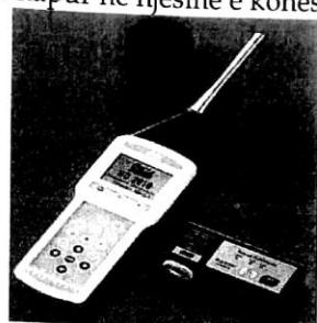
*Fig.4 Fonometri Delta OHM HD 2010 UC per matjen e nivelit te zhurmes*
